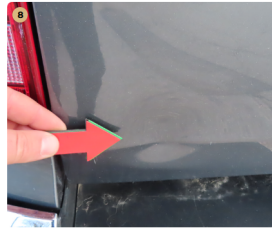
8 csomagtartótető horpadás, karcos, fénysérült
