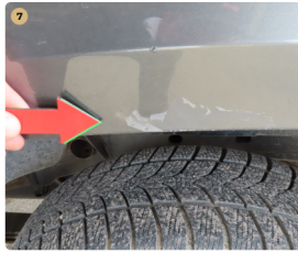
7 bal hátsó sárvédő lakk hiba
