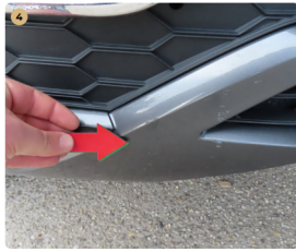
4 első lökhárító kavics sérült, fénysérült
