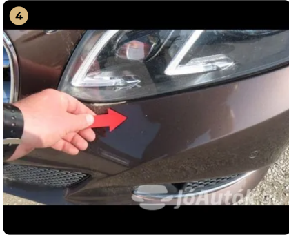
! első véshárító apró kavics sérülések
