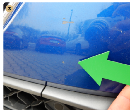
3 első lökhárító kavicsnyomok több helyen
