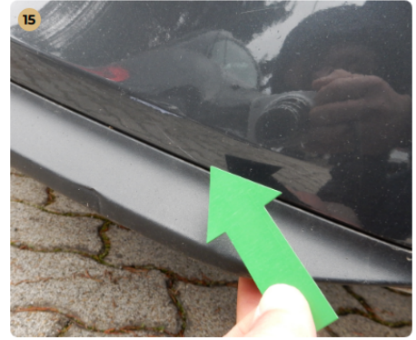
! első lökhárító Horzsolás
