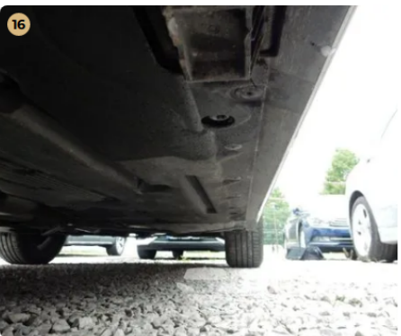
✓ Utascella és gyűrődő zónák A padlólemez burkolatán javításra utaló nyomok nem láthatók. -
