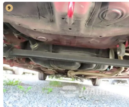
✓ Utascella és gyűrődő zónák A nyúlványokon külsérelmi nyomok nem találhatóak. -
