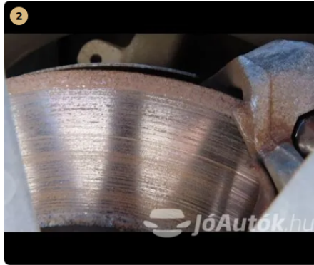
2 ✓ Fékrendszer Féktárcsán állásból adódóan felületi korrózió látható, ami rövid használat után lekopik. -
