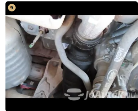
9 ⚠ Motor Egyéb csövön enyhe olajpára lecsapódás
