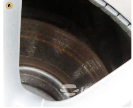
Féktárcsán felületi korrodáció, a sok állástól, javítani nem szükséges.
