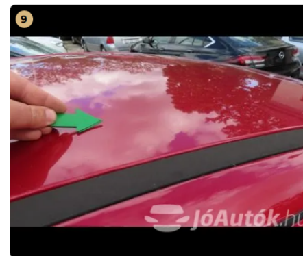
⚠ tető apró horpadások
