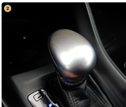
⚠ műszerfal Kopás a váltógombon
