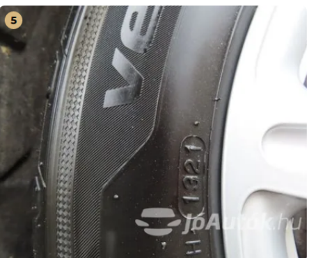
5 Gumiabroncsok A gumi oldalfalán, szálszakadás jele (dudor) nem található. -
