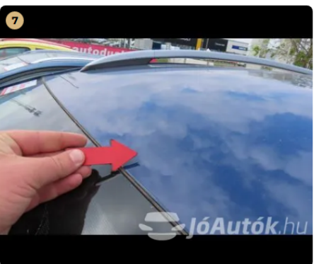
7 ! Külső karosszéria elemek Az autó használatából eredő apró kavicsfelverődések, hajszal karcok láthatóak motorháztetőn és tetőn kavics sérülések és horpadás
