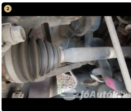
2 ✓ Futómű A féltengelyen zsíros / olajos kicsapódás nem látható. -
