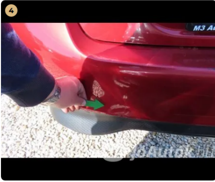
! hátsó vészharító horzsolás ,apró karcok
