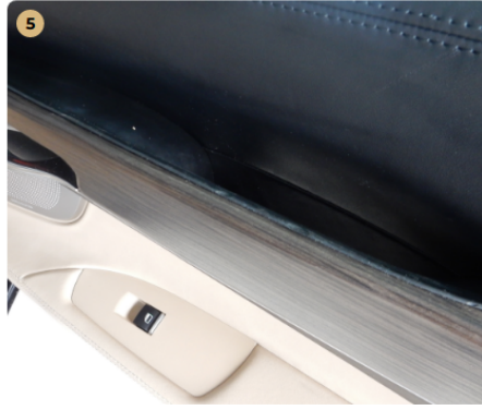
jobb első ajtókárpit Kopások a behúzáson
