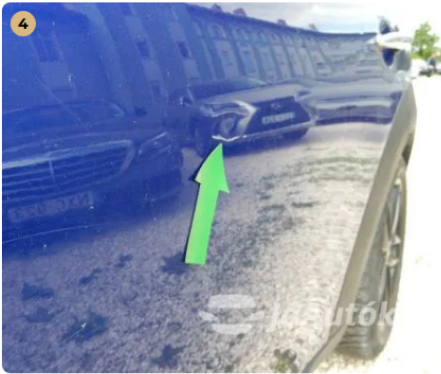
⚠ Apró horpadás a bal hátsó ajtón
