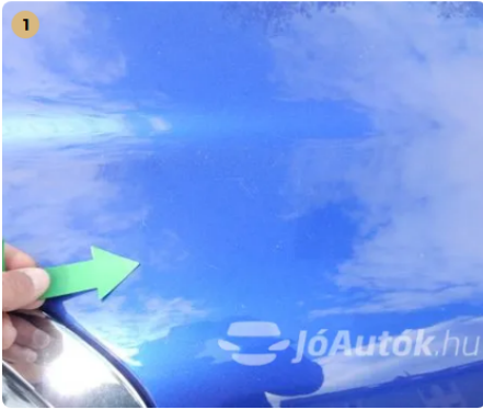
⚠ Kavicsnyomok a motorháztetőn
