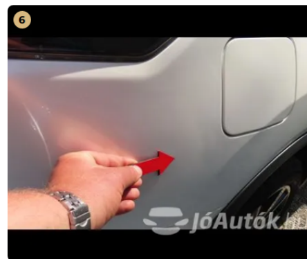
! jobb hátsó sárvédő fényezési hiba, jobb hátsó sárvédő újra lett fényezve
