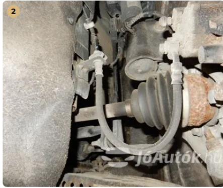
✓ Futómű A gumiharangokon szakadás, repedés nem látható. -
