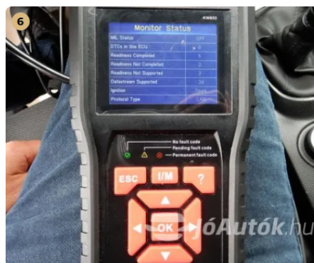
✓ Hibakód kiolvasása Számítógépes kiolvasás során nem találtam hibát. -
